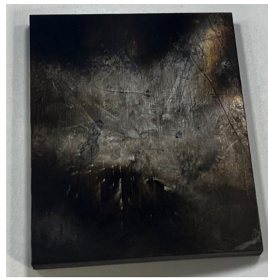
图 10 无涂层树脂基烧蚀后的表面形貌
