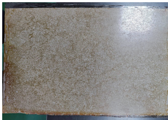
图1 脱模后的试验板
